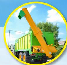
Высокопроизводительный шнек - 7500 кг/мин - специальная версия для силоса - 12м<sup>3</sup>/мин
